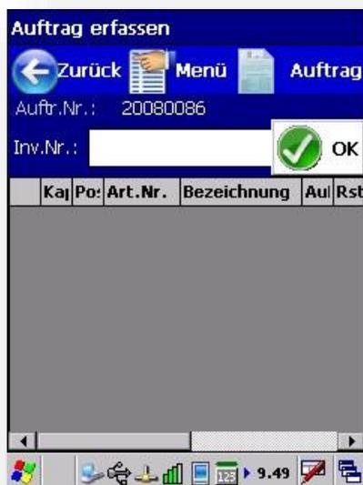
Sie erfassen Sie die gewünschten Auftragspositionen, indem Sie den Barcode der Artikel absキャンen. Gescannt wird dabei die [Inventarnummer](#) eines Artikels. Über diese Nummer kann das Programm die Artikelnummer ermitteln und in der Auftragsposition speichern.
