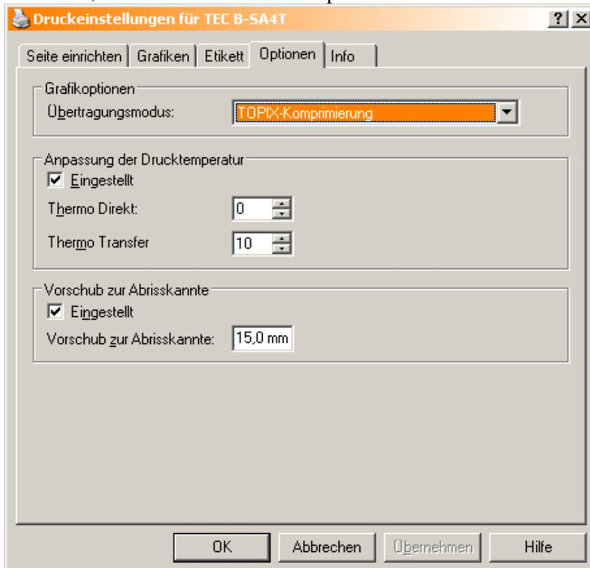
Bei dem Vorschub zur Abrisskante schiebt der Drucker das gedruckte Etikett etwas heraus, so dass man es abreißen kann. Beim nächsten Druck wird das nächste Etikett dann wieder zurückgezogen und bedruckt.
